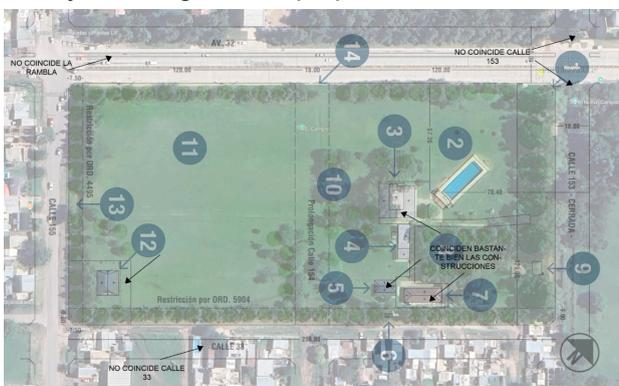
Se proporciona un Plano base rectificado.dwg que incluye la foto aérea como referencia, en el que NO se modificaron las medidas del predio ni de las construcciones a conservar o a tener en cuenta para el Plan Integral.
